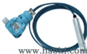
DBS500 系列投入式静压液位变送器是基于所测液体静压与该液体高度成正比的原理，采用扩散硅或陶瓷敏感元件的压阻效应，将静压转成电信号。经过温度补偿和线性校正。转换成 4-20mA DC 标准电流信号输出。
