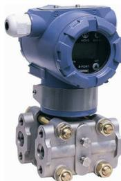
用于测量炉内压等微小差压，然后转变成 4~20mA DC 信号输出。HSB-3351DR 智能型微差压变送器也可与 HART 手操器相互通讯，通过它进行设定，监控或与上位机组成现场监控系统。HSB-3351DR 现场调整式智能差压变送器是本公司根据现场要求研制开发的新产品，可脱离手操器，通过按键方式实现现场调零、组态等操作。
