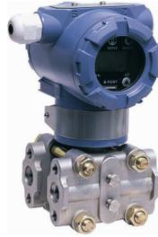
HSB-3351GP 型压力变送器主要用于测量气体、液体和蒸汽的压力、负压力等参数, 然后将其转换成 4~20mA DC 信号输出。Gp 型压力变送器的  $\delta$  室, 一侧接受被测压力信号, 另一侧则与大气压力贯通, 因此可用于测量表压力或负压。
