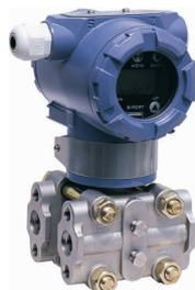
HSB-3351DP 差压变送器主要用于测量液体、气体或蒸汽的差压、压力、液位和密度，然后将其转换成 4~20mA. DC 信号输出。
