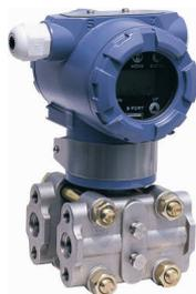
HSB-3351 流量变送器与节流装置配套测量液体、气体或蒸汽的流量然后将其转变成 4~20mA DC 信号输出。
